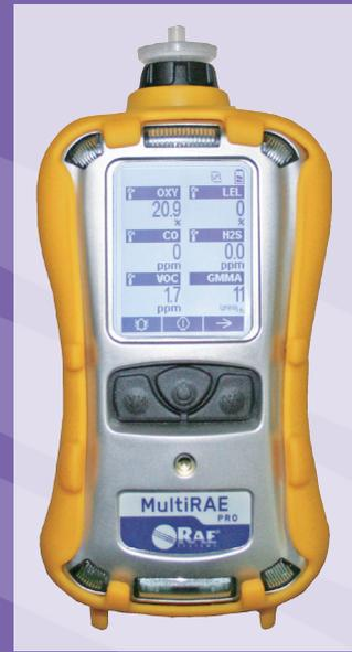
MultIRAE 2 是华瑞公司最新开发的新一代六合一复合式气体检测仪，适用包括 EC、LEL、TC、PID、IR、Gamma 等在内的所有 RAE 传感器，各种传感器可任意组合、灵活配置。检测精度高，使用于各种危险环境使用。
